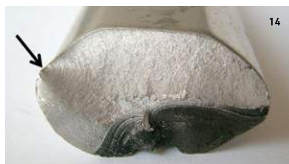
Fig. 14. Esempio di frattura a fatica, punto di innesco, linee di propagazione, zona di schianto.
