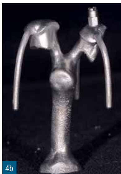
Figg. 4a,b Tecnica della fusione a cera persa con componenti Calcinabili e Ucla.
